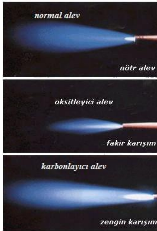
Resim 3.2: Oksi-gaz kaynağında alev yapısı
