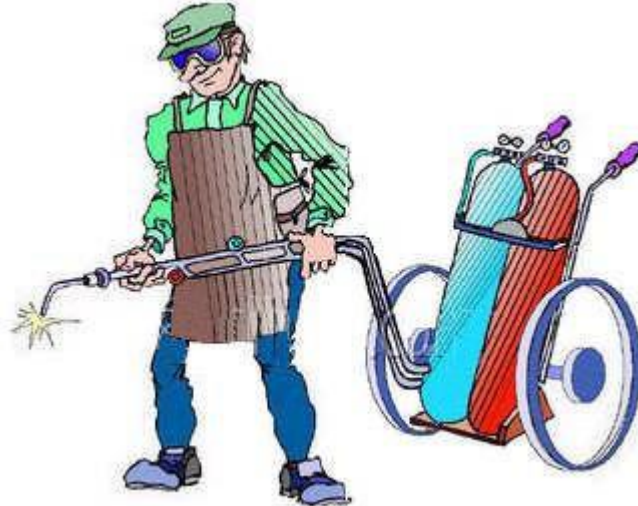
Seyyar oksijen gaz kaynağı postası
